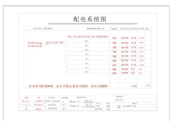
配电系统图（范本）---三相平衡
